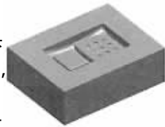
图4 包含岛及雕塑曲面的模具型腔
