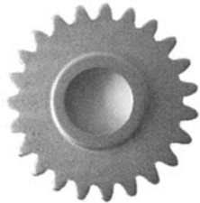
图 14 利用优化后的工艺参数制造的齿形零件 Fig. 14 The gear wheel part produced through using optimized process parameters
